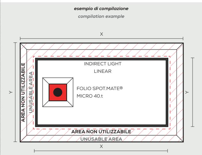
Disegna la forma del tuo pannello Zero Grid indicando tutte le quote. Le dimensioni minime e massime dei pannelli variano a seconda del tipo di installazione scelto (vedi dettagli a pagina seguente). Definisci la quantità, la posizione e la tipologia degli accessori illuminotecnici Folio da inserire **all'interno dell'area utilizzabile**. I disegni saranno da verificare in fase di produzione dall'ufficio tecnico Folio.
