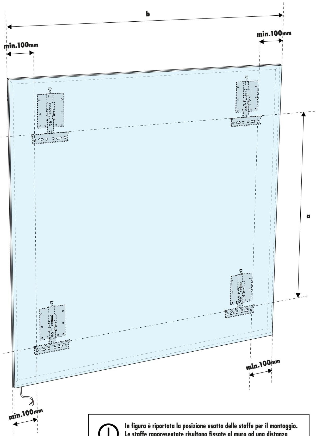
**!** In figura è riportata la posizione esatta delle staffe per il montaggio. Le staffe rappresentate risultano fissate al muro ad una distanza orizzontale equivalente di 100 mm dall'esterno al centro del primo foro staffa.
