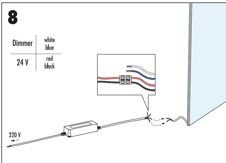
**!** Assicurarsi di togliere la corrente, collegare il cavo del pannello LED al trasformatore come mostrato nel punto 8. Collegando il cavo rosso **+** del pannello con il cavo rosso **+** del trasformatore e il cavo nero **-** del pannello con il cavo nero **-** del trasformatore. Successivamente collega il trasformatore all'impianto con il cavo 220 V e inserisci la corrente.
