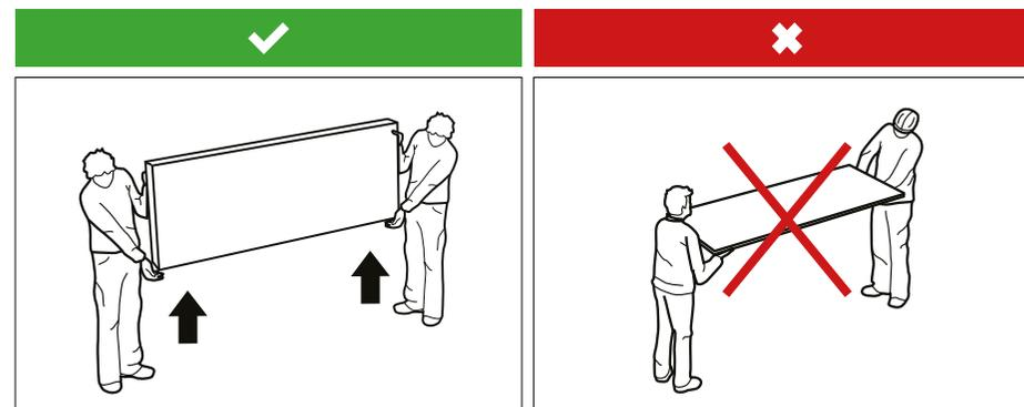
Trasportare il pannello Folio mantenendolo sempre in costa, evitando ogni possibile imbarcamento.
