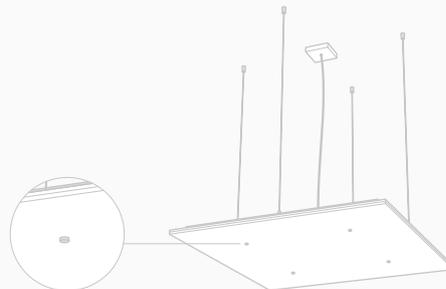
La posizione delle borchie è strettamente correlata alla dimensione del pannello e va valutata con l'ufficio tecnico Folio.
