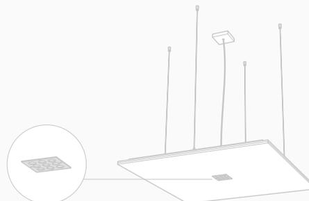
Le viti di fissaggio possono essere abbinata all'installazione di Domino Quad e Domino Linear (Spot.Mate®) con mascherina sagomata.
