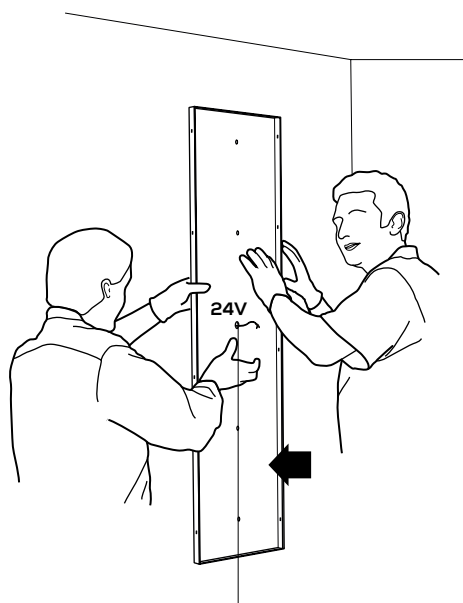
FORO CAVO 24V CABLE HOLE 24V
