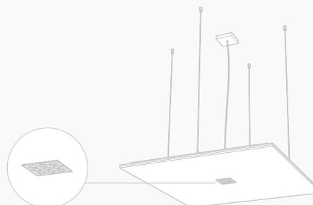
Le viti di fissaggio possono essere abbinata all'installazione di Domino Quad e Domino Linear (Spot.Mate®) con mascherina sagomata.
