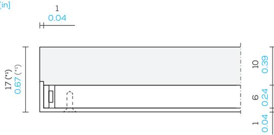
(\*) Lo spessore della sezione si riferisce a CCT statici, IP standard e lati LED standard
